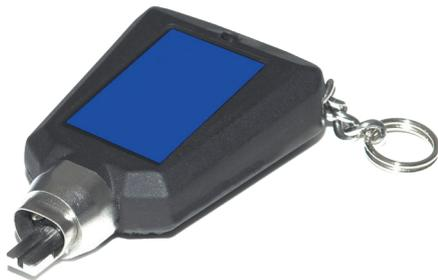
Der Multifunktionsschlüssel mit integrierter Batterie wird verwendet, um Konfigurationsdaten (Systemcodes, Schließungsnummer, Berechtigungen und Sperrungen) in die Schließungen zu übertragen, bzw. Zutrittslisten auszulesen. Die Aufgaben, für die der Schlüssel berechtigt ist, werden ihm durch die Software mitgeteilt. Dabei können mehrere Multifunktionsschlüssel für die verschiedenen Aufgaben in einer Schließanlage angelegt werden.
