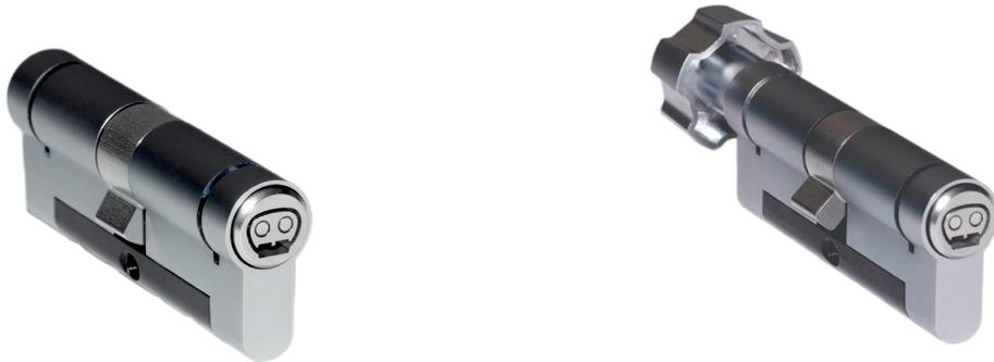
Mechatronische Schließzylinder mit gekapselter Elektronikbaugruppe nach DIN EN 15684 / DIN 18252 / EN 1303 für den Einbau in Europrofilenschlössern nach DIN 18251. Geeignet zum Einbau in Schlösser nach DIN 18250 (Feuer- und Rauchschutz). Wartungsarm durch kontaktbasierte Spannungsversorgung bei Betätigung mit dem Schlüssel.
