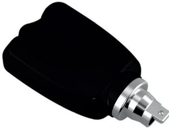
Der Nutzerschlüssel mit integrierter Batterie versorgt die Schließungen während des Öffnungs- und Schließvorgangs mit Energie, um die Zutrittsberechtigung zu überprüfen und im Falle eines berechtigten Zutritts die Schließungen betätigen zu können. Die Programmierung des Nutzerschlüssels erfolgt mittels eines im Schlüssel integrierten NFC-Chips entweder über ein RFID/NFC basiertes Programmiergerät, NFC fähiges Smartphone oder virtuell vernetzt über einen Türmanager.
