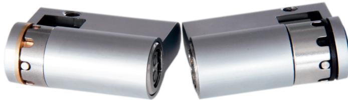
Mechatronischer Schließzylinder mit gekapselter Elektronikbaugruppe nach DIN EN 15684 / DIN 18252 / EN 1303 für den Einbau in Europrofilenschlössern nach DIN 18251. Wartungsarm durch kontaktbasierte Spannungsversorgung bei Betätigung mit dem Schlüssel.
