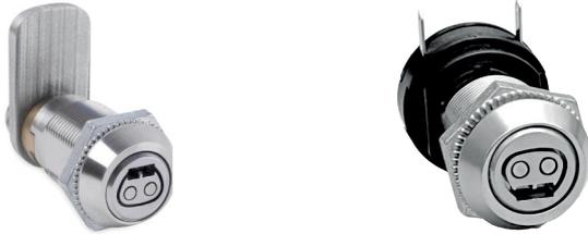
Mechatronische Hebelzylinder mit gekapselter Elektronikbaugruppe. Diese mechatronischen Schließzylinder arbeiten batterieles und sind somit wartungsarm. Die Spannungsversorgung erfolgt kontaktbasiert durch den Schlüssel, während der Betätigung. Die Hebelzylinder sind in Varianten mit unterschiedlichen Gewindedurchmessern, Drehwinkeln und Hebelformen erhältlich. Kundenspezifische Varianten können auf Anfrage geliefert werden.
