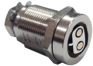
Mechatronische Kompakt-Schließzylinder mit gekapselter Elektronikbaugruppe für den Einsatz in gesicherten Automaten oder Vitrinen. Diese mechatronischen Schließzylinder arbeiten batterieles und sind somit wartungsarm. Die Spannungsversorgung erfolgt kontaktbasiert durch den Schlüssel während der Betätigung.
