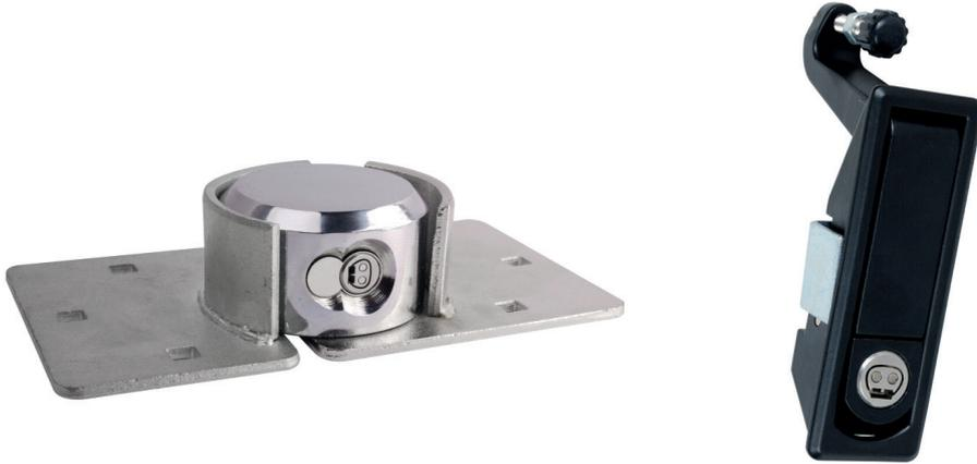
Mechatronische Zylinder und Schließungen für Spezialanwendungen mit gekapselter Elektronikbaugruppe. Diese mechatronischen Sonderlösungen mit integriertem Schließzylinder arbeiten batterieless und sind somit wartungsarm. Die Spannungsversorgung erfolgt kontaktbasiert durch den Schlüssel, während der Betätigung.
